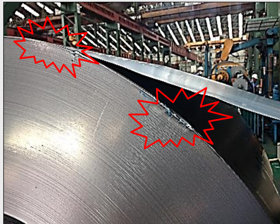
รูป ตัวอย่างสินค้าที่จัดเก็บในพื้นที่โซน 1A wu Defect ขอบข้างถูกเบียด (Edge Damage)
