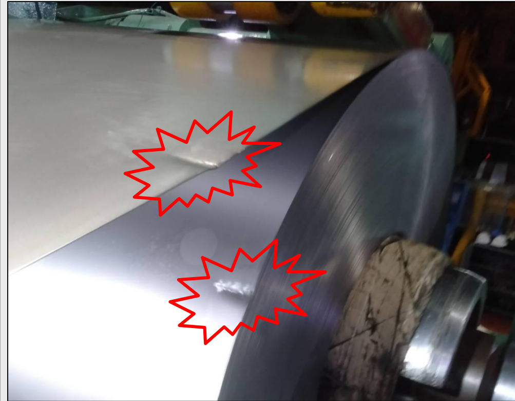
รูป ตัวอย่างสินค้าที่จัดเก็บในพื้นที่โซน 1A wu Defect รอยบุบ (Dent)
