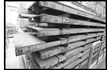
Steel Pallet สามารถเลื่อนปรับความยาวได้ เพื่อเป็นการลดการผลึก Steel Pallet หลายๆ ขนาด
